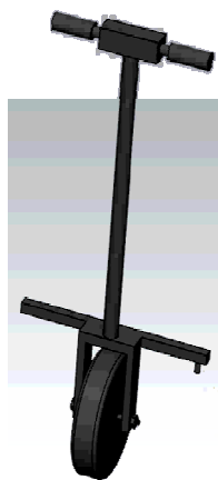
Рис. 1. Разработанная конструкция универсальной стойки
