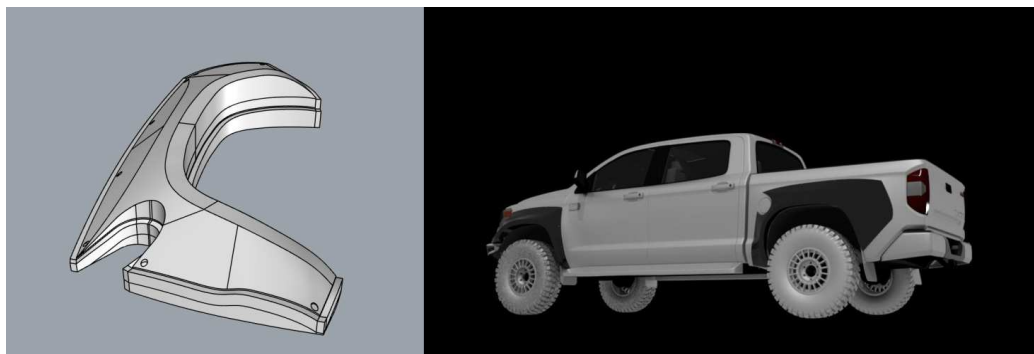
Рис. 4. 3D матрица и 3D модель расширений
