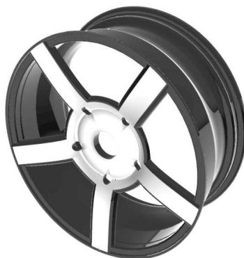
Рис.4. 3D модель прототипа диска VossenCV-3
