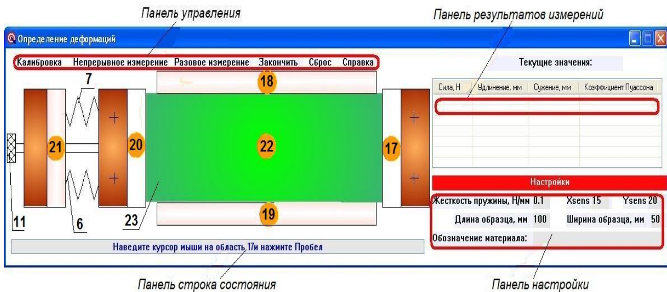
Рис.3.11 - Интерфейс программы “Определение деформационных параметров” волокнистых систем
