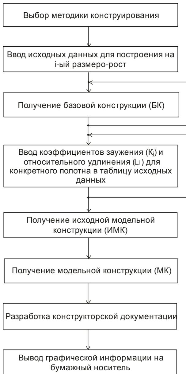
Рисунок 2. - Укрупненный алгоритм процесса получения рациональных конструкций в САПР швейных изделий
