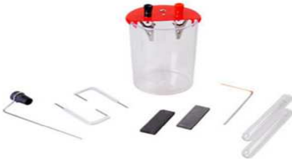
Рис. 3. Пластиковый контейнер для процесса электролиза
