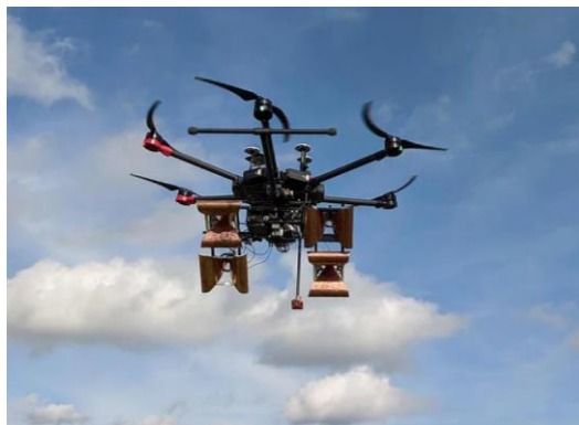
Рисунок 4 – Георадар на борту БПЛА (по: https://www.ue-stiftung.org/findmine )
