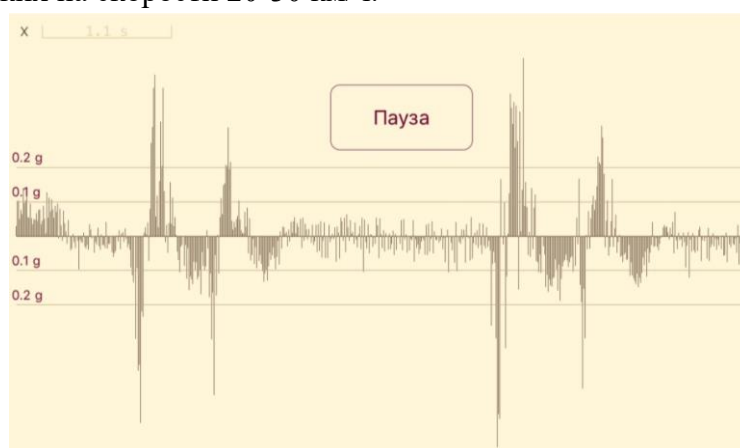
Рисунок 1 – Переезд двух «лежачих полицейских» (скорость 20-30 км/ч)
