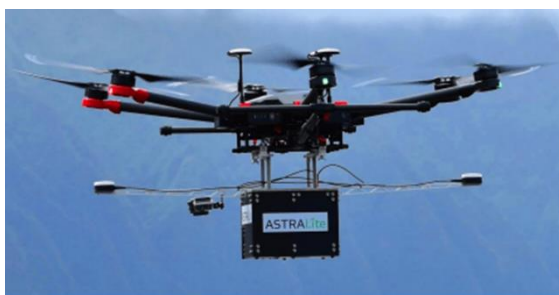
Рисунок 2 – Лидар «Edge» компании Astralite на БПЛА DJI Matrice 600 Pro
