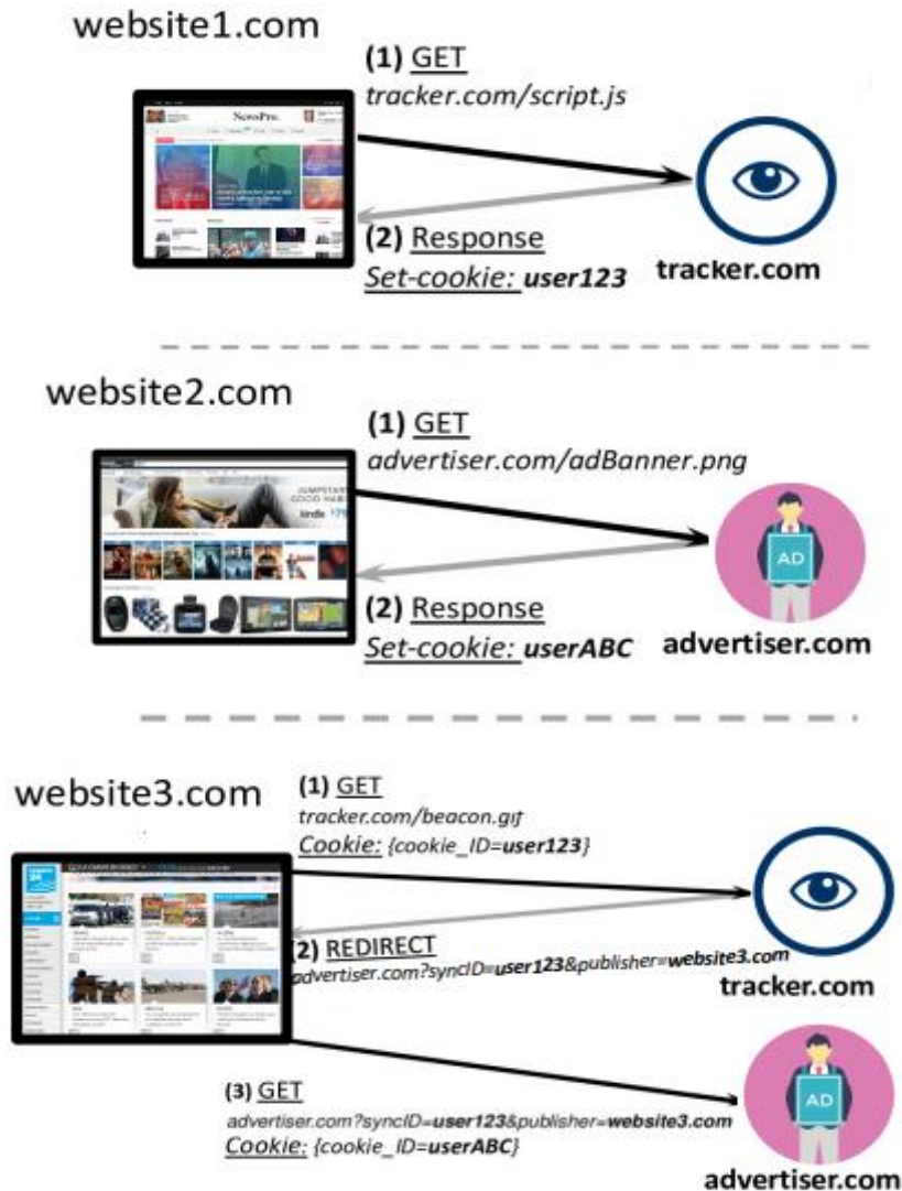
Рисунок 1: Пример операции синхронизации идентификатора. Два соответствующих идентификатора, которые они присвоили одному и тому же пользователю.
